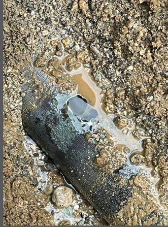
11h58. La conduite révèle un trou d'un diamètre de 5 cm.
